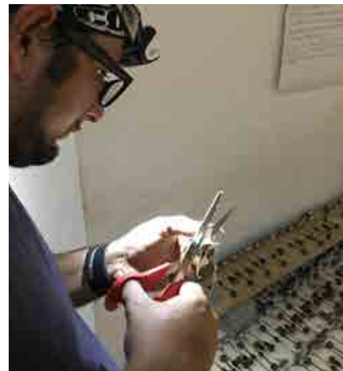
↑ Sorgfältig schneidet Joslay Hernández die Lederdichtungen für den Abzugdraht des Ventils Joslay Hernández corta cuidadosamente las juntas de cuero para el cable de tiro de la válvula
